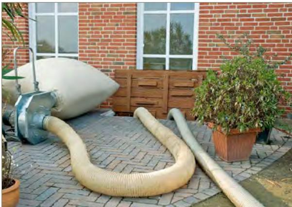
Abb. 4: Absaugventilator mit Staubsack
