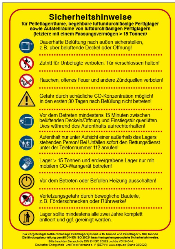
Abb. 32: Sicherheitshinweise für Pelletlagerräume, begehbare luftundurchlässige Fertiglager sowie Aufstellräume großer luftdurchlässiger Fertiglager
